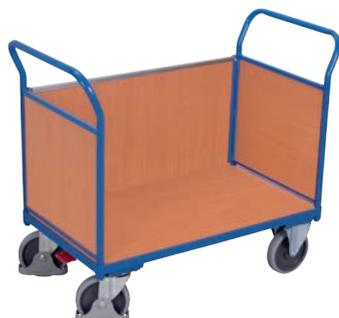
Baukasten-System; Bodenkonstruktion mit dem innovativen L-Profil; Ladefläche aus Holzwerkstoffplatte; Oberfläche Buchendekor; Wagen pulverbeschichtet RAL 5010 enzianblau; dauerhaft oberflächengeschützt; schlag- und kratzfest; Bereifung aus thermoplastischem Gummi auf Kunststofffelge mit Präzisions-Rillenkugellager, grau, „spurlos“; Faden- und Fußschutz; 2 Lenkrollen mit **EasySTOP** und 2 Bockrollen.
