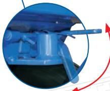
Automatische Sicherung der Zugöse.
